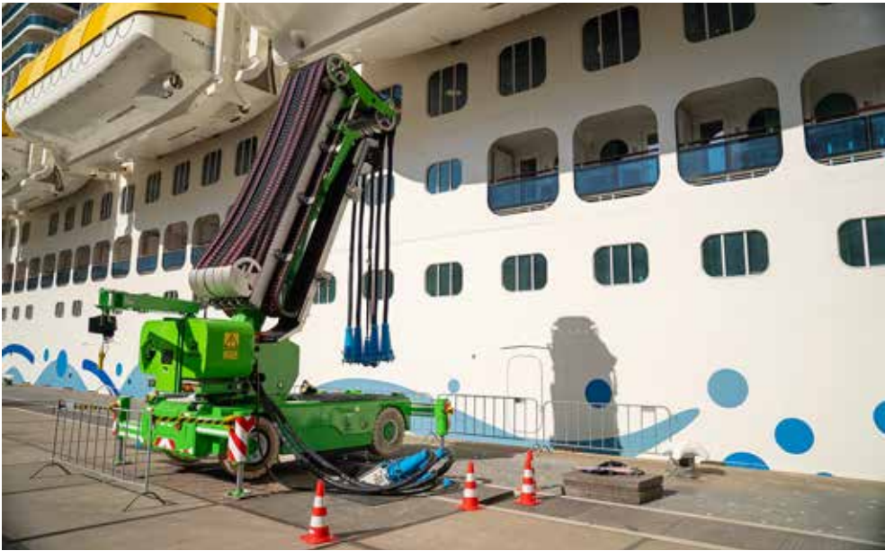
▲ Het flexibel inzetbare aansluitvoertuig is inzetbaar over een breedte van 230 meter. (foto's Havenbedrijf Rotterdam)
